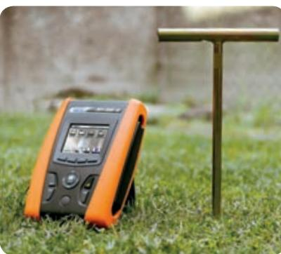
使用伏安法测量接地电阻
