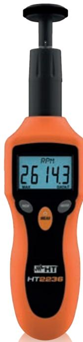
**HT2236** 是一款数字转速计数器，用于测量旋转机械部件（圆盘、驱动轴等）的速度，无论是接触式还是非接触式，可利用目标物透射和反射的光束进行测量计数。
