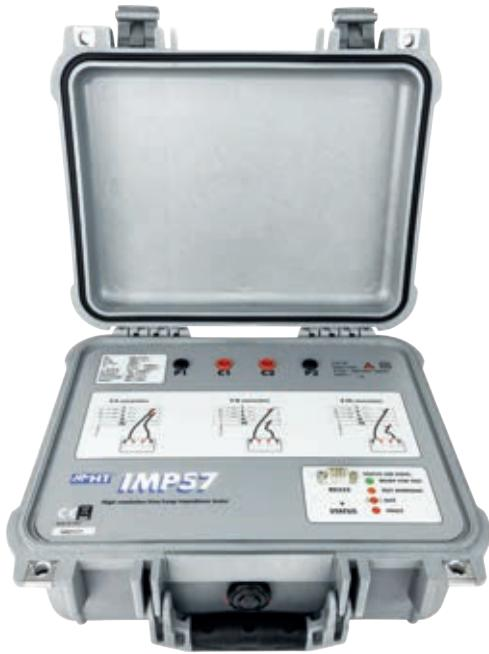
**IMP57** 是一个可选附件，用于测量环路/线路故障环路阻抗并计算假定的短路电流。**IMP57** 可与 **GSC**、**SIRIUS**、**Combi** 和 **Macrotest Gx** 系列设备以及 **ZG47**、**Fulltest3** 和 **Speed418** 系列设备一起使用。产生的高测试电流（约200A）允许以高分辨率（ $0.1\text{m}\Omega$ ）进行测量，因此即使在**MT/BT**变压器柜（**TN**系统）附近也能获得正确和精确的结果，并且通常，在设备的基本分辨率不足以保证根据项目的理论数据正确测量假定短路电流的情况下进行测量。**IMP57** 采用舒适耐用的外壳结构，没有显示屏，可以通过串行 **RS232** 连接到主机设备以读取结果。**4** 端子测量允许不考虑所提供的电缆电阻的影响，因此无需进行初步使用的电缆校准。
