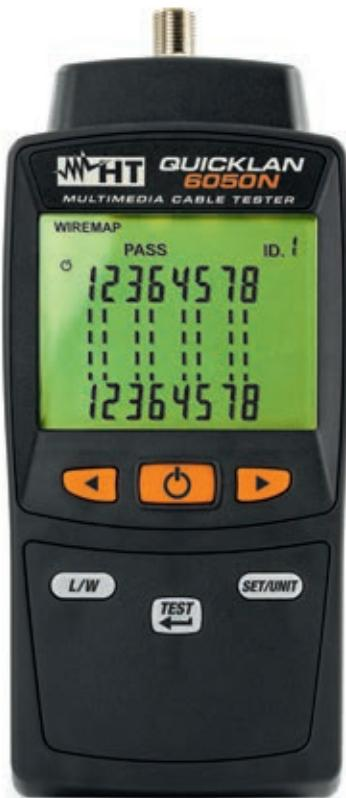
型号 QUICKLAN6050N 能够检测并指示在显示的 LAN 网络电缆（交叉、分离、颠倒、开路、短路、配对等）上是否存在不正确的连接，这两种连接均具有 UTP 类型（非屏蔽）和 STP 类型（屏蔽）连接器 RJ45、RJ11 和同轴 F。该设备具有更多远程设备，能够识别更多（RJ45 型）装置，以便在内部不同位置创建高效的定位操作配补丁面板，在单个操作员的帮助下非常快速地执行测试。QUICKLAN6050N 还测量电缆单对的长度。
