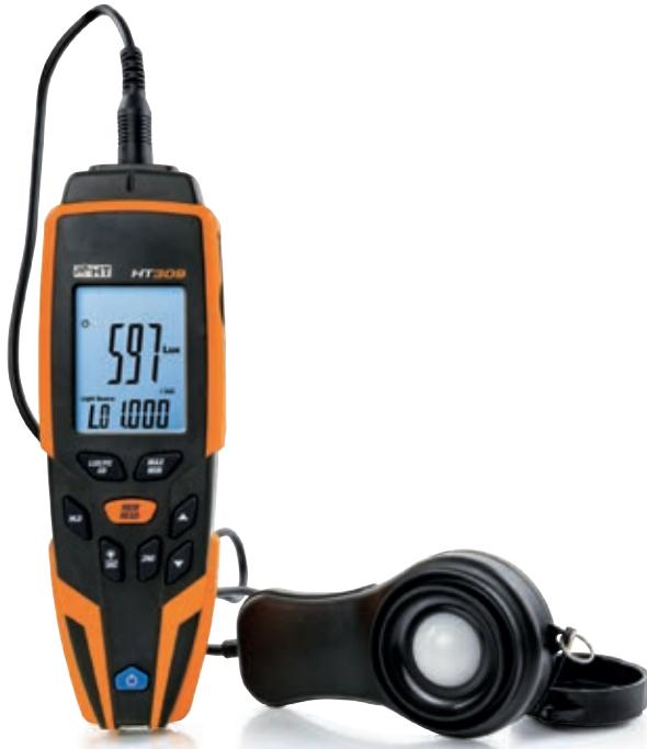
**HT309** 型是一款数字照度计，用于通过硅光二极管传感器测量高达 400kLux 的照度。该型号还允许使用通过设置相关校正系数，测量发光强度（表示为在蜡烛光强中）并将测量结果保存在内部存储器中。
