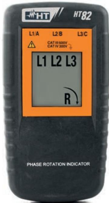
HT82是移动式设备，采用三个端子检测显示普通3相系统的相序。
