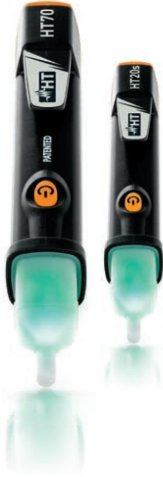
HT70是一款实用、创新型仪器，能够执行相位检测功能、检测相序、进行相序一致性测试，具有LED指示与蜂鸣器提示，同样能够在绝缘保护套上进行测量。只需简单地将传感器在L1上移动，然后在L2上移动，检测结果由红色的LED（相序不正确）与绿色LED（相序正确）指示。而HT20s是专门用来搜索带电电缆的仪器，同样可以在电缆绝缘保护套上测量，不用接触带电部件。
