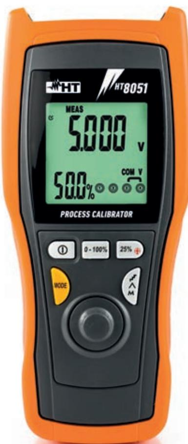
HT8051是专业的过程校准仪表，采用了创新的设置刻度盘，设置数值后，能够产生、测量直流电流与电压信号，最高可达10V与24mA。测量、生成电流时，可以设置以百分比形式显示数据，与设置的数值相对应（0% = 4mA, 100% = 20mA）。电压与电流信号的产生同样可能使用最多3个可选择的渐进方式。该机型可以测量直接由仪器供电的外部转换器的电流消耗，在整个读数范围内模拟可调电流的转换器。仪器根据安全标准IEC/EN61010-1设计，配有双重绝缘电机，每项功能通过前面板上的专用按键选择。该仪器是典型工业自动化应用与实验室工作的理想解决方案。
