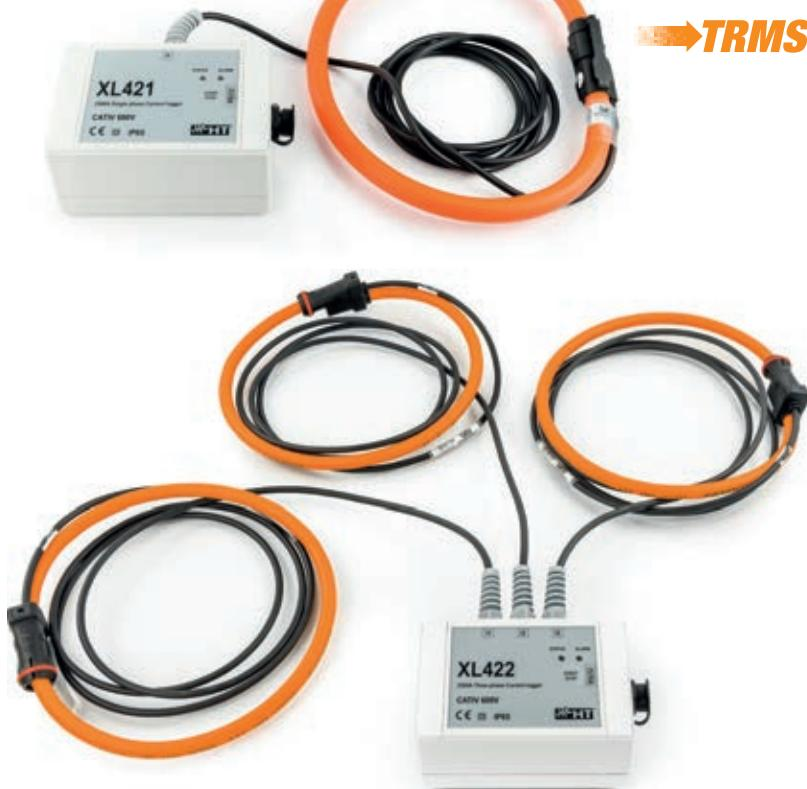
数据记录仪XL421（单相）和XL422（三相）能够测量、记录单相和三相电力系统中不同应用中最高2500A交流电流的真有效值（计算负载电流值、变压器的额定功率等）。该仪器放置于实用的防水塑料箱内，并配有集成的柔性夹钳，能够围绕大尺寸电缆或母线。采用了高级的内存管理算法，能够对系统进行长时间监视。该设备根据采样周期开始记录，可以通过软件对采样周期在1、6、30与60秒之间选择。内存快满时，根据采样周期后面的值对原来记录的数据进行“重新采样”，释放部分内存，然后设备采用新的测量间隔，继续记录新的数值。该仪器就最多可以记录1年的数据，将记录保存在内存中，可以通过专用软件使用PC进行下载与管理。同时XL421数据记录仪还配有特殊的粘性胶带，可以放置在设备中任何需要测量的地方。保护等级高（IP65），设备能够完全在各种极端条件中可靠使用。
