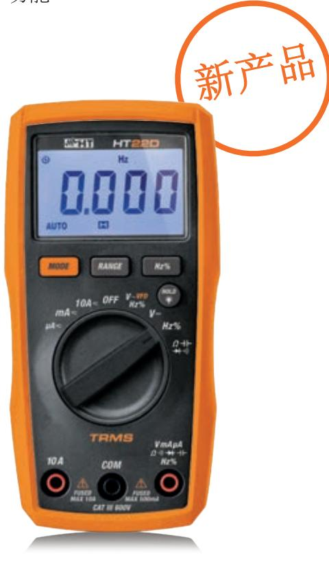
HT22D 型号是一款 TRMS 数字万用表，用于测量高达 600V 的 DC/AC TRMS 电压、高达 10A 的 DC/AC TRMS 电流、电阻、连续性测试、频率、占空比、容量和二极管测试，符合 IEC/EN61010-1 安全标准，测量类别为 CAT III 600V。该仪器具有创新的**VFD** (变频驱动器) 功能，可精确测量交流电压，甚至在**变频稳压器 (逆变器)** 的下游也是如此。此外，还具有数据保持功能、大型背光显示屏和自动关机功能，可在不活动时自动关机。
