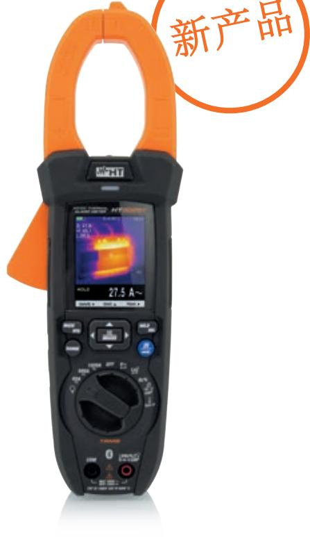
HT9025T 将专业电流钳的与 120 x 120pxl 红外热像仪相结合成多功能测试仪。它设计用于测量高达 1000A 的 AC/DC 电流、高达 1500V 的直流电压和 TRMS 中的交流电压高达 1000V，达到 CAT IV 600V 和 CAT III 1000V 符合 IEC/EN61010-1 安全标准。电流钳表配有一个测量点显示屏，具有背光和条形图模拟指针显示，即使在光线不足的环境中也能获得清晰的读数。HT9025T 还可以使用 K 探头和集成热像仪进行温度测量。蓝牙连接可实现数据传输使用专用 HTMercury 应用程序保存的红外热图与数据。
