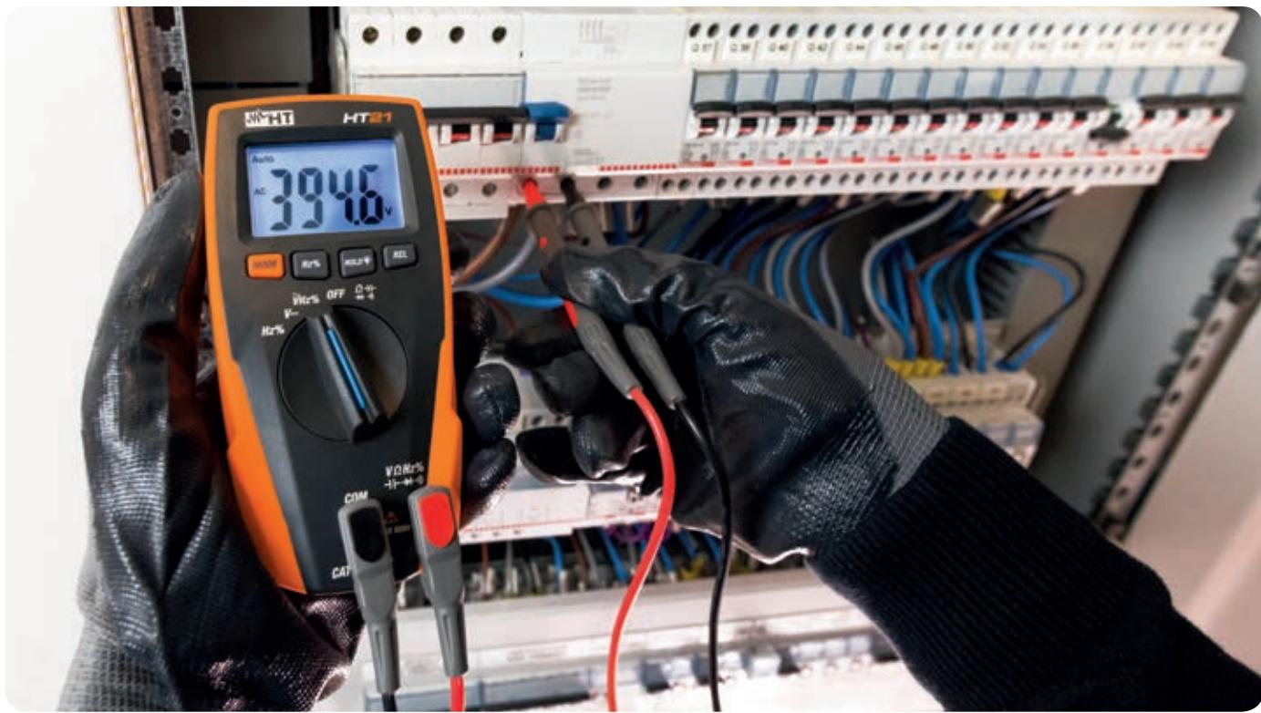
HT21、HT211 和 HT25N 型号是紧凑型数字万用表，主要测量高达 600V 的 AC/DC 电压和高达 10A（除 HT21 外）的直流电流测量，具有电阻、连续性测试、二极管测试和 HT25N 更具有 9V 和 1.5V 碱性电池等互补功能电池测试。这些仪器的设计符合安全标准 IEC/EN61010-1，在 CAT III 600V 中具有双保护绝缘。它们配有带背光的宽 LCD 显示屏，每个功能都可通过相关开关进行选择。此仪器的进一步功能是数据保持 HOLD，用于冻结显示屏上的实时测量的相关数据，HT211 还提供了用提有用于 K 型探头测量温度的功能，HT 也提供了可选的 TK1xx 温度测量探头。
