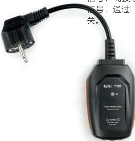
对于需要在电力线中检测参考开关的工程师而言, HT38属于将工作变得更加容易的仪器(不是必要的仪器)。仪器包括两个元件: HT38T与HT38R。HT38T插上电源后能够产生信号,而接收器HT38R能够识别该信号,通过LED与声音指出参考开关。
