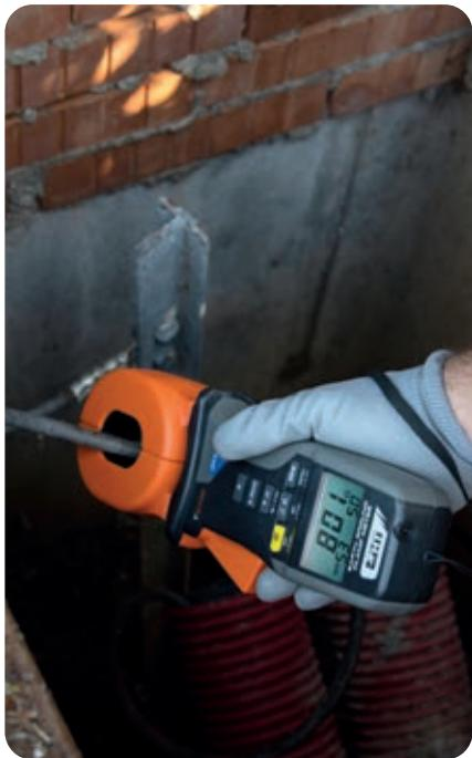
使用钳形表T2100测量接地电阻
