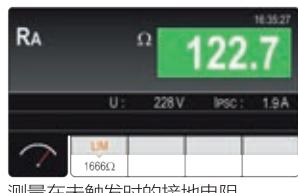
测量在未触发时的接地电阻
